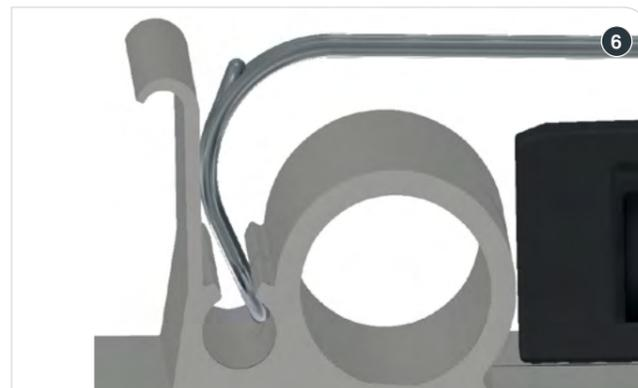
Die Sicherungsklammer wird am Kreuzungspunkt eingehängt...
