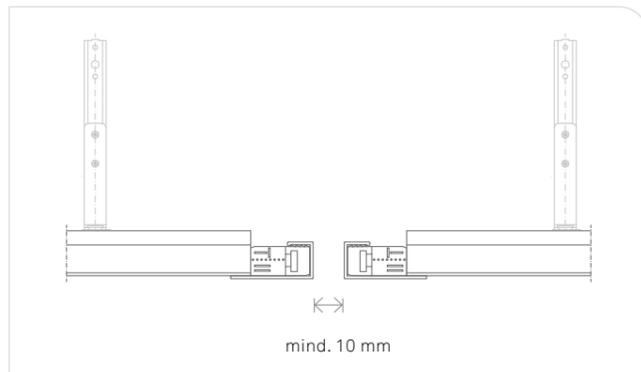
Die bauseitigen Dehnungsfugen sind generell zu übernehmen. Spätestens aber alle 10.800 mm in der Hauptschiene.
