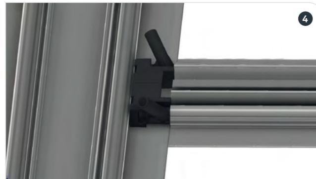
Das Nonius Unterteil ES wird von oben eingeklickt oder kann seitlich eingeschoben werden, auch bei bereits montiertem Profilendstück. Die Rasternase wird händisch abgebrochen und um 180° gedreht als Kreuzungspunkt verwendet.
