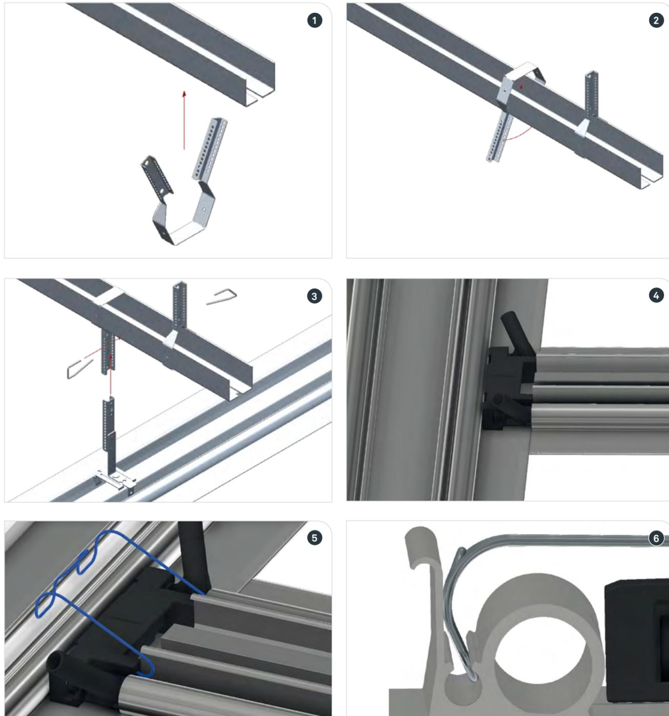
Die Sicherungsklammer wird am Kreuzungspunkt eingehängt...
