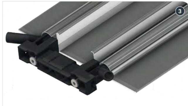
Das Nonius Unterteil ES wird von oben eingeklickt oder kann seitlich eingeschoben werden, auch bei bereits montiertem Profilstück. Die Noniusabhängung muss lotrecht eingebaut werden.
